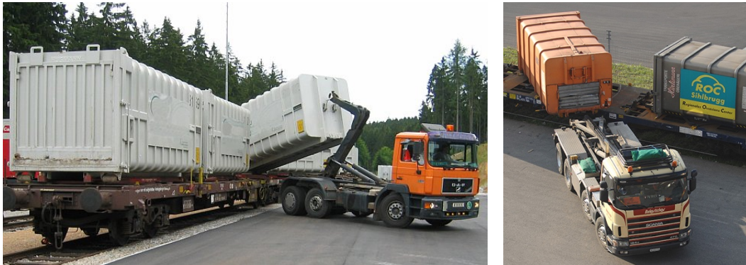
Abb. 18: ACTS- Transportsystem in Anwendung (Quelle: ACTS)
