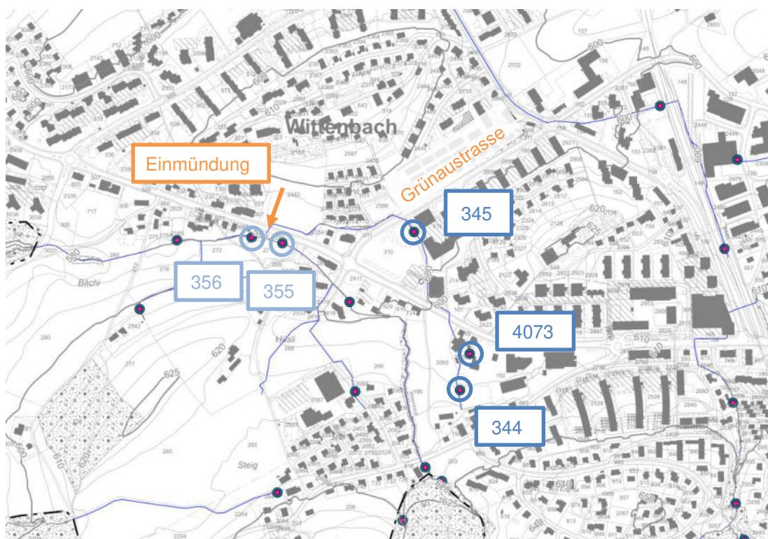
Abbildung 4: Hydropunkte Gefahrenquellen, Geoportal 07.07.2022
