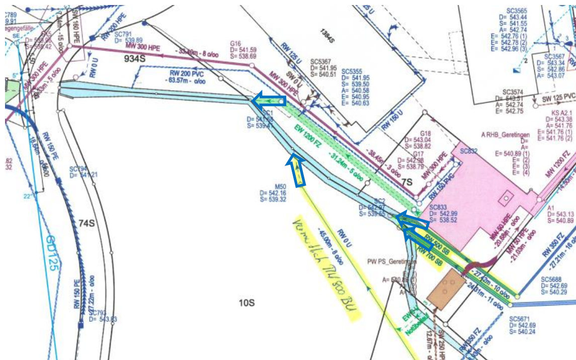
Abbildung 7: Auszug Werkplan Abwasser; Massgebende Einleitungen in den Gerendingerbach (blaue Pfeile), dazugehörige Rohrstränge sind grün und oder gelb eingefärbt.
